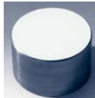
Leeb Härtevergleichsplatte Leeb hardness reference block
