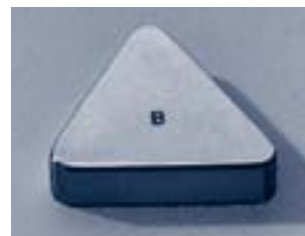
Knoop Härtevergleichsplatte Knoop hardness reference block
