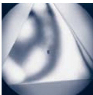
Ebenheitsprüfung an Makro-Platten Flatness test on macro blocks
